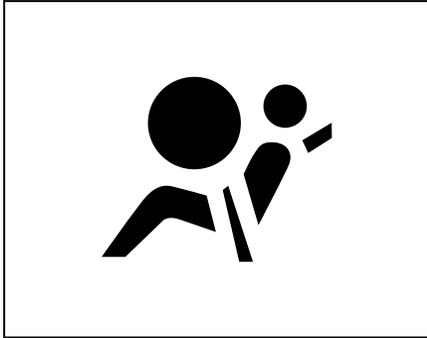
На приборной панели установлен индикатор подушки безопасности (показан справа), на котором отображается символ подушки безопасности.
