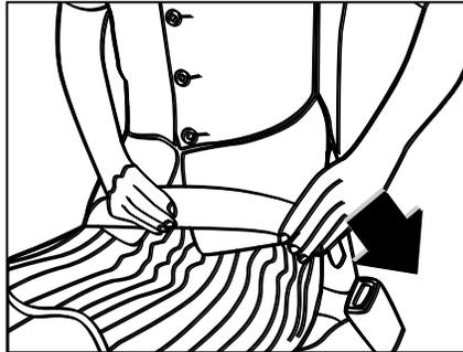
Удерживая пряжку рукой, вставьте металлическую пряжку ремня безопасности в соответствующее сиденье пряжки. Когда металлическая пряжка заблокирована, раздается щелчок. В ручную отрегулируйте натяжение ремня безопасности.
