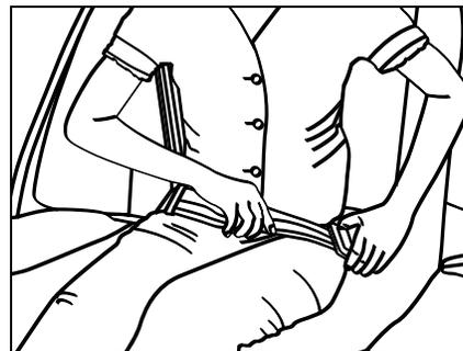
Укоротите ремень безопасности, просто потянув свободный конец ремня на нужную длину и закрепив излишек ремня безопасности пластиковой пластиной.
